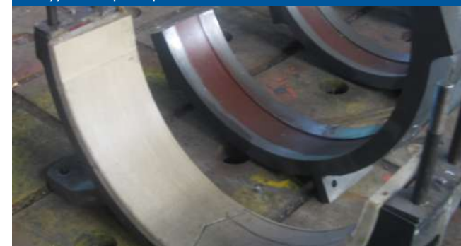
Подшипниковая опора ДТВО-100, материал капрлон
