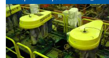
флотомашина, материал «Укрепан»®
