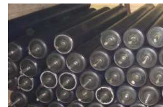
Ролик конвейера Ø 159x1600 мм.
