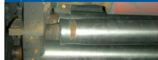
Ролики грохота, материал «Абразивэласт»®
