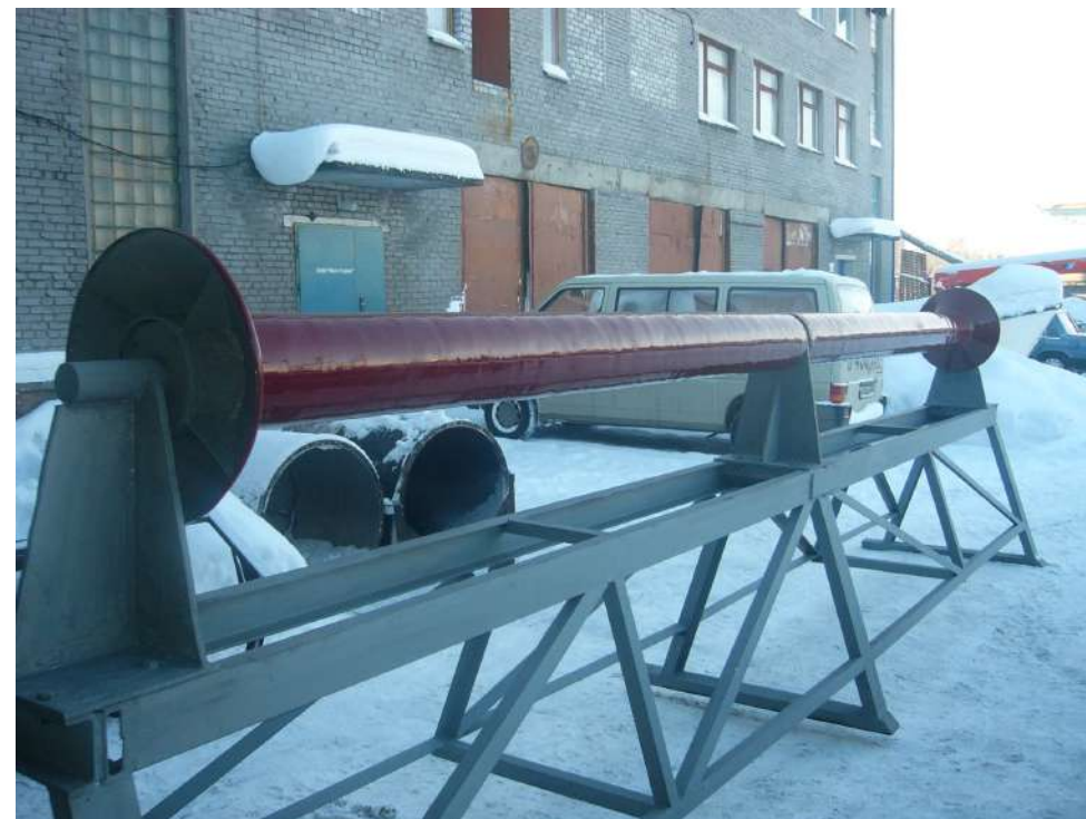
Рол опорный загрузочного топливного шланга. Облицован полиуретаном для значительной сохранности шланга.
