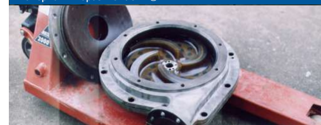
Корпус насоса, материал «Абразивэласт»®
