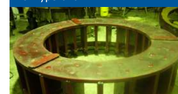
статор РИФ-1300, материал «Абразивэласт»®
