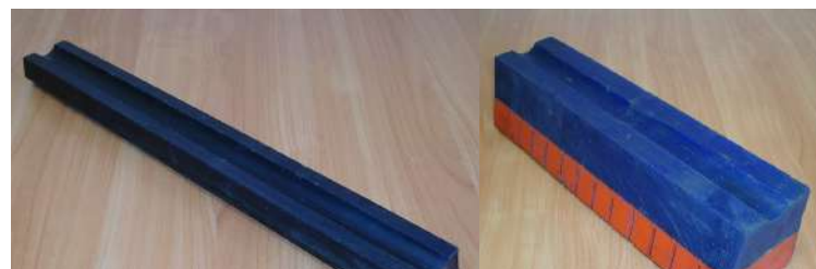
Футеровки отклоняющего шкива многоканатной подъемной установки ШП-4 длинная и короткая
