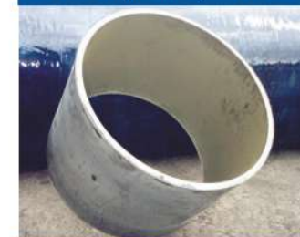
Втулка грузового ролика обжиговых тележек Замена проектной бронзы на капролон увеличила срок службы втулок до 10 раз.
